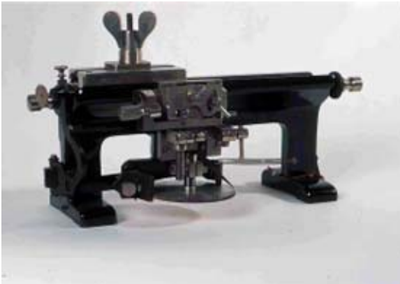
Uno de los modelos de micrótopo, que corta finas secciones para la observación microscópica, frecuentemente utilizado en los laboratorios de la época de Ramón y Cajal (MNECN)
