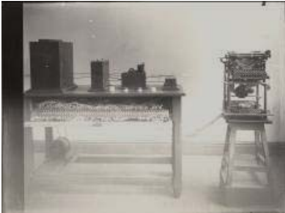
Aritmómetro electromagnético de Torres Quevedo, calculadora gobernada a distancia por una máquina de escribir dotada de contactos eléctricos, de un dispositivo de escritura de los resultados, memoria y un coordinador automáticos (Centro de Tecnologías Físicas Torres Quevedo, CTQ)
